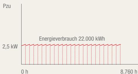
Jährliche Energieeinsparung von 6.470 kWh (~1.500 EUR) durch wöchentliche Filterreinigung
