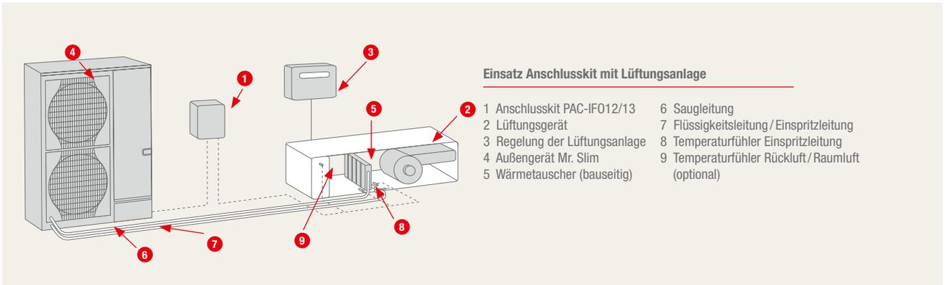
**Schnittstelle zur Anbindung von Lüftungsgeräten**
