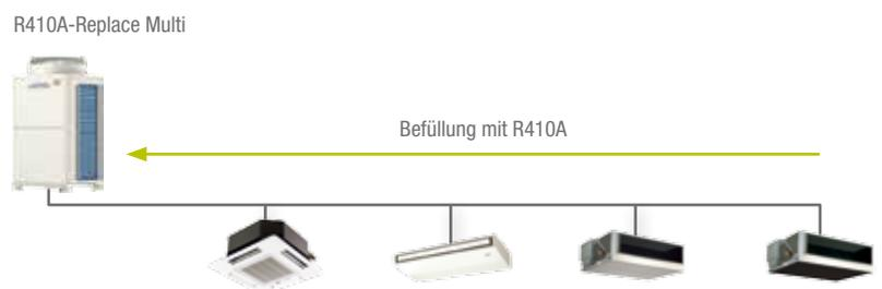
Austausch einer R22 VRF-Klimaanlage ohne Rohrleitungstausch erfolgreich durchgeführt
